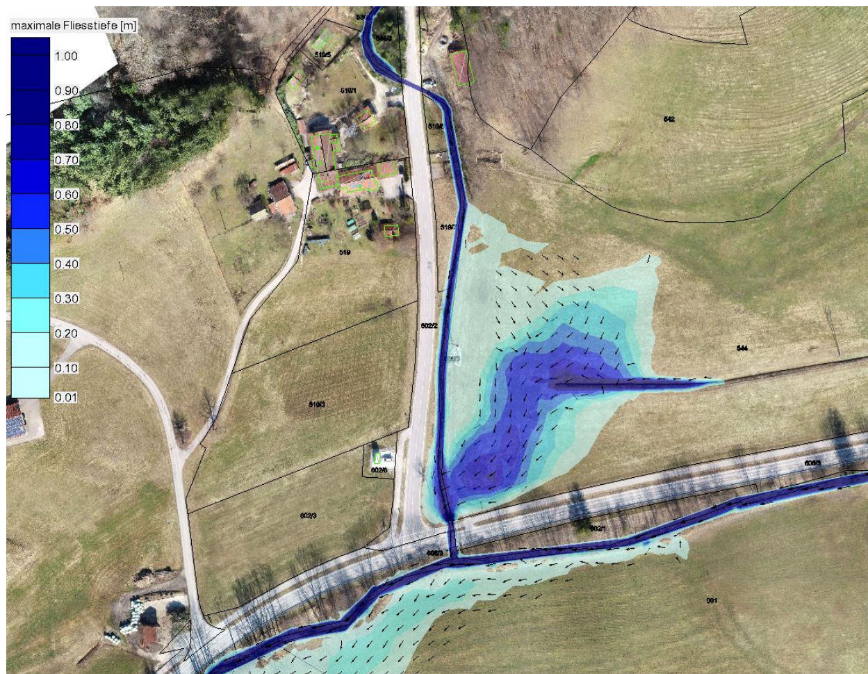
Abbildung 6.10: Planungszustand: Maximale Fließtiefe HQ 100 , Höllgraben
